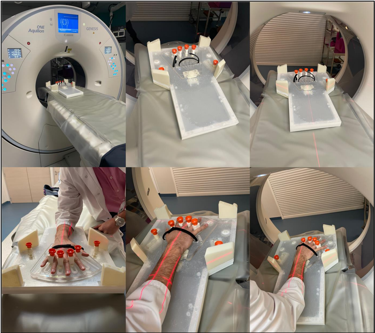
Figure 39. Photographie montrant la compatibilité en termes d'encombrement du dispositif avec la table d'examen du scanner Aquilion One du service d'imagerie Guilloz. À noter la simulation hors acquisition scanographique, de l'installation sur le dispositif du membre supérieur droit d'un médecin volontaire.
