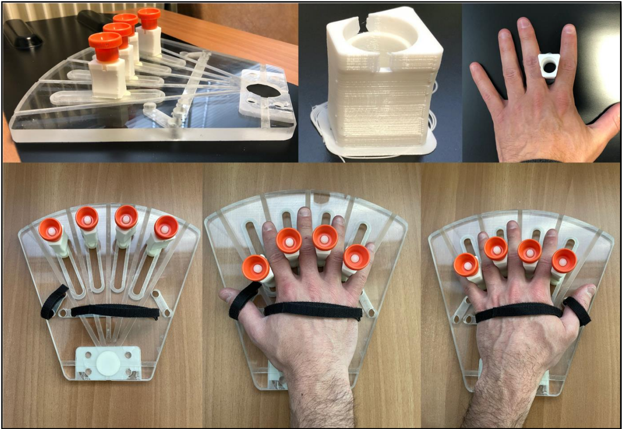
Figure 35. Photographies de la partie mobile amovible avec son système de stabilisation de la main. À noter l'adaptabilité selon la latéralité et les dimensions du membre.
