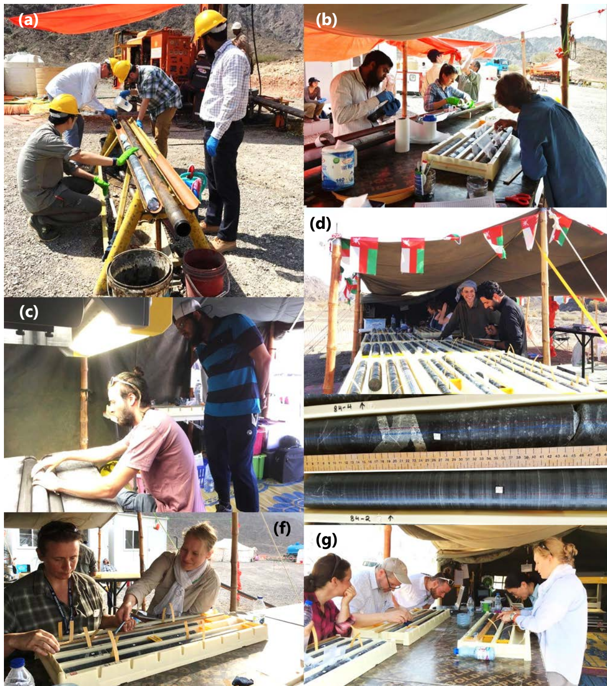
Fig. XI. 4. Photographies de la campagne de forage de l'Oman Drilling Project dans la région de Batin. (a) Nettoyage des carottes à leur sortie du puits. (b) Classement et archivage des carottes. (c) Scan tridimensionnel des carottes. (d-g) Observation et description des structures macroscopiques (veines, imprégnations...) et des lithologies. Sources: Oman Drilling Project (2018), D. Jousselin et D. Klaessens.
