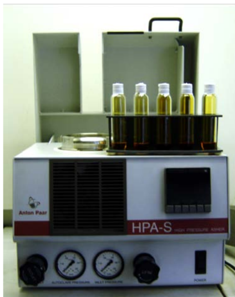
Fig. VIII. 4. Autoclave High Pressure Asher (HPA-S; Anton Paar) du CRPG, qui permet la digestion acide des échantillons placés dans tubes en quartz à 100 bars et à 285°C pendant 15 heures.
