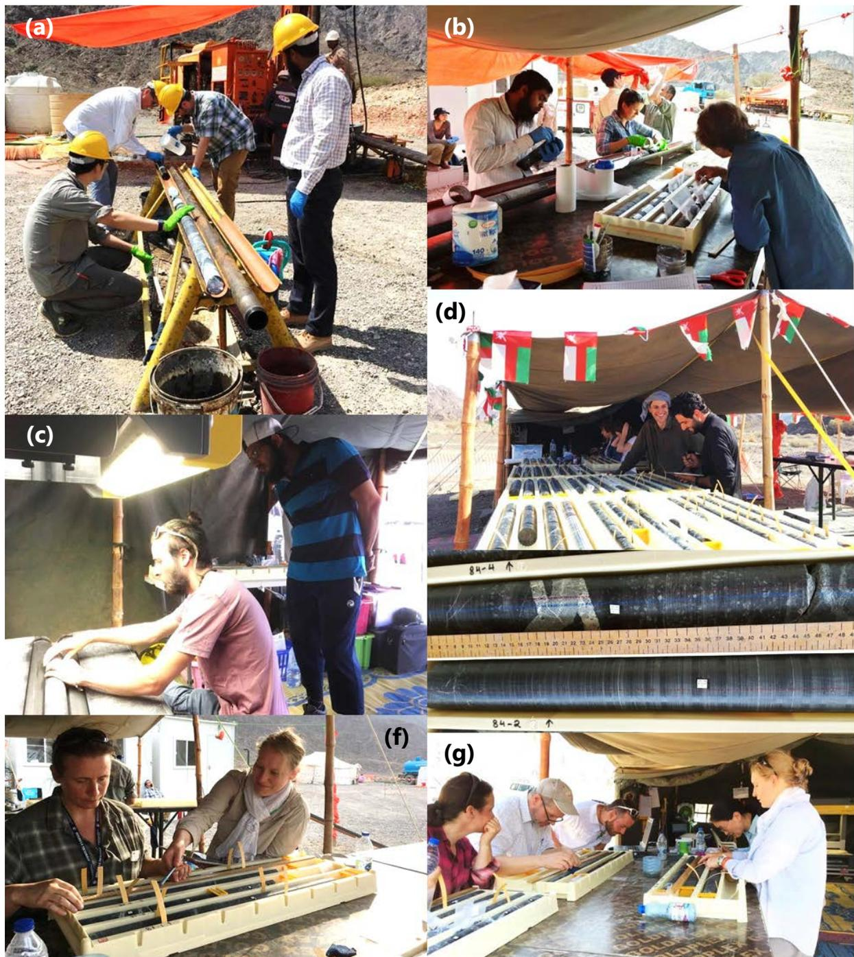
*Fig. XI. 4. Photographies de la campagne de forage de l'Oman Drilling Project dans la région de Batin. (a) Nettoyage des carottes à leur sortie du puits. (b) Classement et archivage des carottes. (c) Scan tridimensionnel des carottes. (d-g) Observation et description des structures macroscopiques (veines, imprégnations...) et des lithologies. Sources: Oman Drilling Project (2018), D. Joussein et D. Klaessens.*
