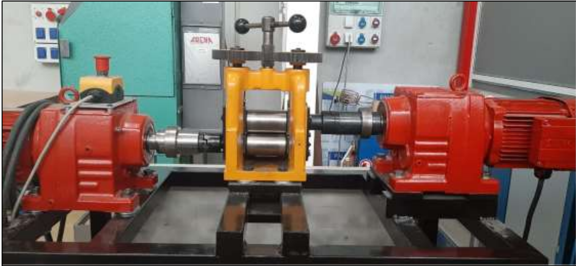
Figure 2.3 Dispositif de laminage à froid
