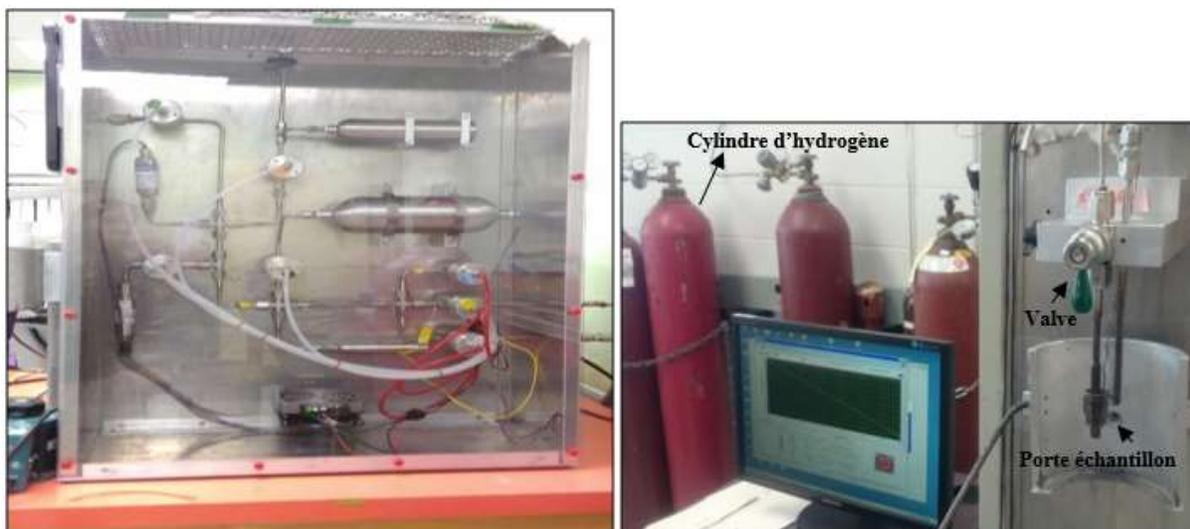
Figure 2.4 Appareil d'hydrogénation type Sievert
