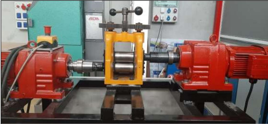
Figure 2.3 Dispositif de laminage à froid
