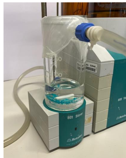
Figure 14 : montage expérimental pour la détermination de la solubilité des phytates métalliques
