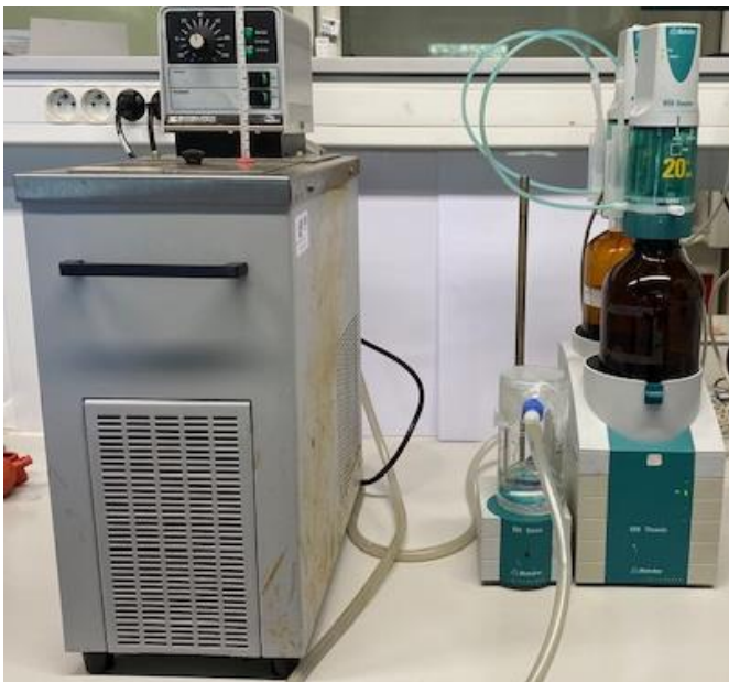
Figure 14 : montage expérimental pour la détermination de la solubilité des phytates métalliques
