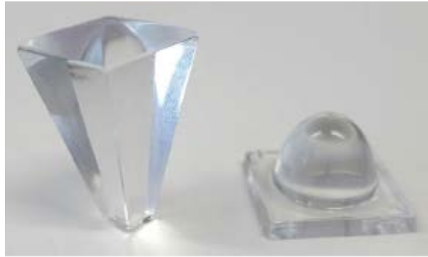
FIGURE 2.24 – Photographie des deux SOEs : à gauche, kaléidoscope en dôme ; à droite, SILO[89] .
