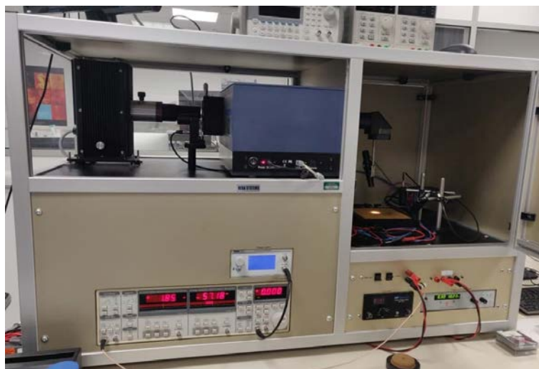
FIGURE 4.18 – Photo du banc de mesure de l'EQE.
