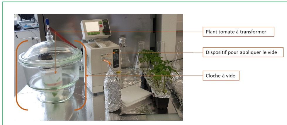
Figure 18 : Montage de l'infiltration sous vide des jeunes plants de tomate.
