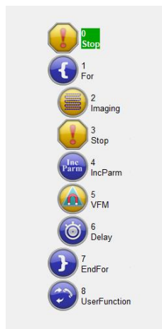
Figure III-13. Un exemple de macro qui permet de réaliser un cycle d'images MFM sous champ magnétique en variant de manière progressive, sans la présence l'opérateur, l'intensité du champ magnétique appliqué.
