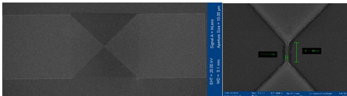
Figure VI-4. Image SEM d'un dispositif d'excitation des ondes de spin réalisé sur membrane pour un échantillon  $[\text{Co/Ni}]_n$  de 50nm. Les dimensions de l'antenne sont de  $1\mu\text{m} \times 100\text{nm}$ , avec une épaisseur de  $\text{SiO}_2$  égale à 40 nm.
