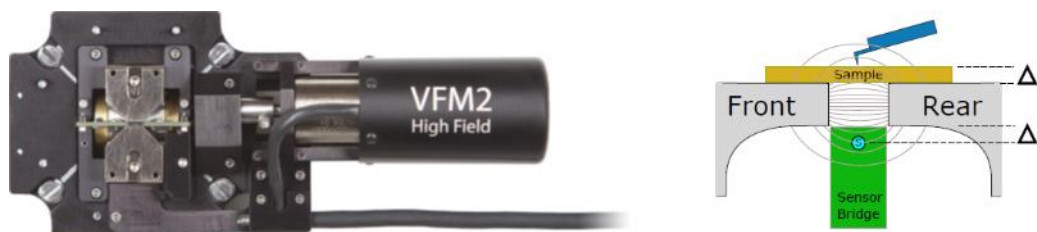
Figure III-12. A gauche, image de dessus du dispositif d'application de champ magnétique. A droite, illustration de l'arrangement des pôles magnétiques en configuration planaire montrant l'emplacement de la sonde de Hall et les lignes de champ issues du circuit magnétique (vue de côté). Tirées de [109].
