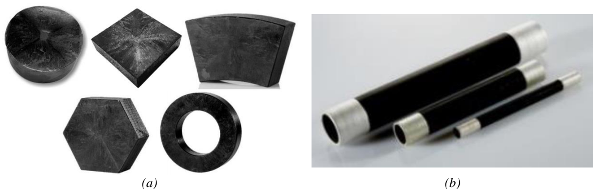
Figure I-10 Structures de supraconducteurs massifs [CAN] (a) Pastilles (b) Amenées de courant.
