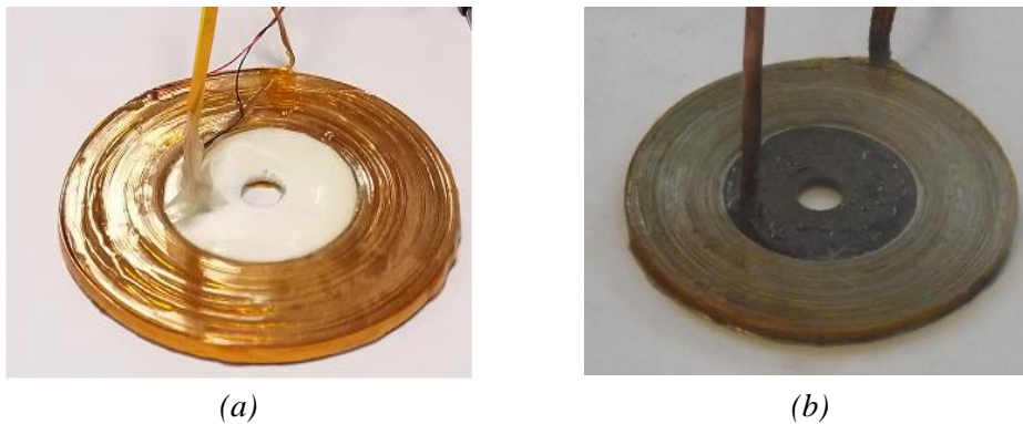
Figure II-16 Bobines utilisées pour l'estimation des pertes fer (a) Bobine en cuivre (b) Bobine supraconductrice.
