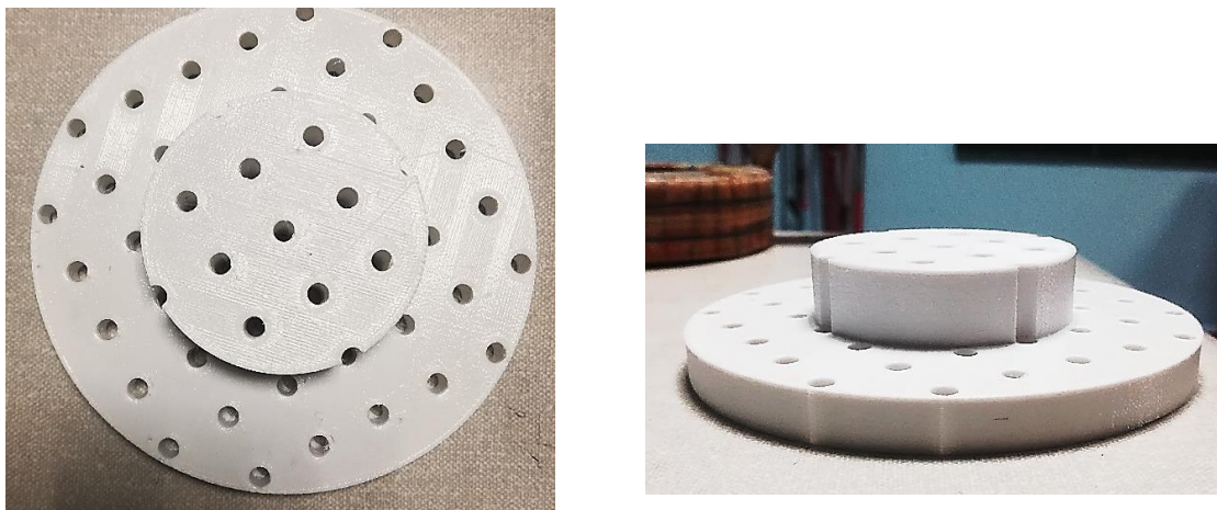
Figure 4.3. Base imprimée en 3D contenant des trous pour faciliter l'assemblage et le refroidissement par l'azote liquide. Le supraconducteur est placé au-dessus de la partie centrale de cette base, et l'inducteur est placé sur la couronne extérieure.
