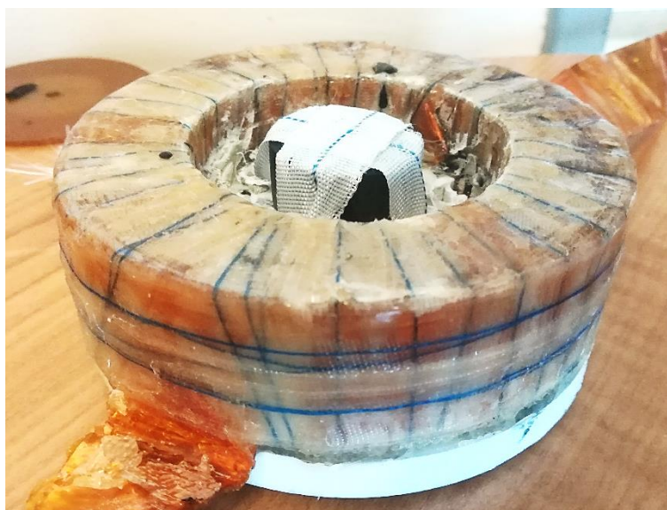
Figure 4.4. Prototype I final pour l'aimantation d'une pastille supraconductrice.
