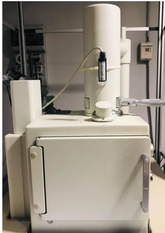
Figure 6. Photographie du spectromètre de dispersion en énergie X installé au LRGP à Nancy-France.
