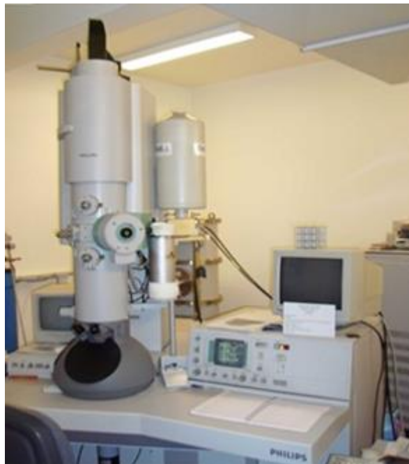
Figure 5. Microscope électronique à transmission installé à Mulhouse-France.
