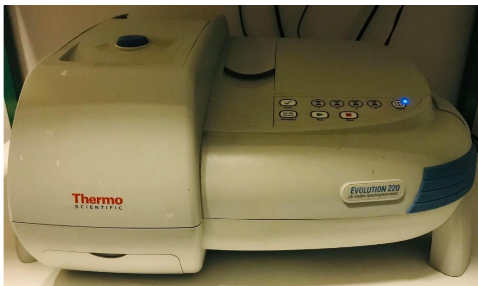
Figure 8. Photographie du Spectrophotomètre d'absorption UV-Visible installé au LRGP à Nancy-France.
