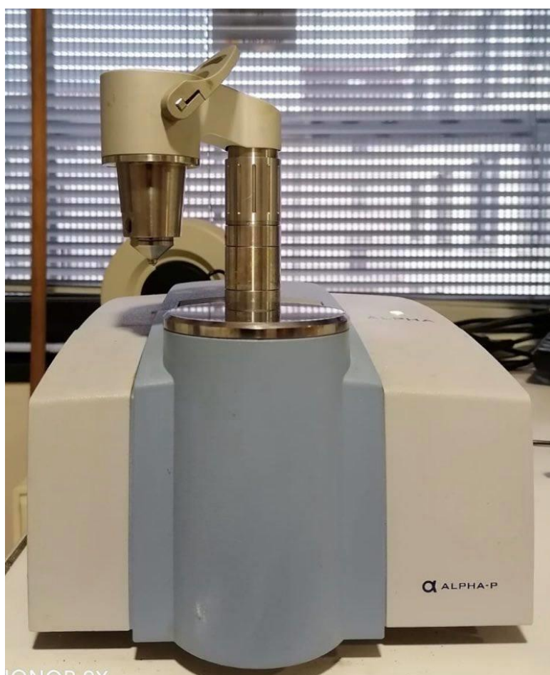
Figure 7. Photographie du Spectromètre Infrarouge à Transformée de Fourier installé au LRGP à Nancy-France.
