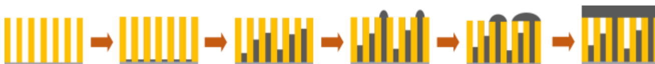
Figure 5.1: Illustration des différentes étapes de l'électrodéposition assistée par membrane
