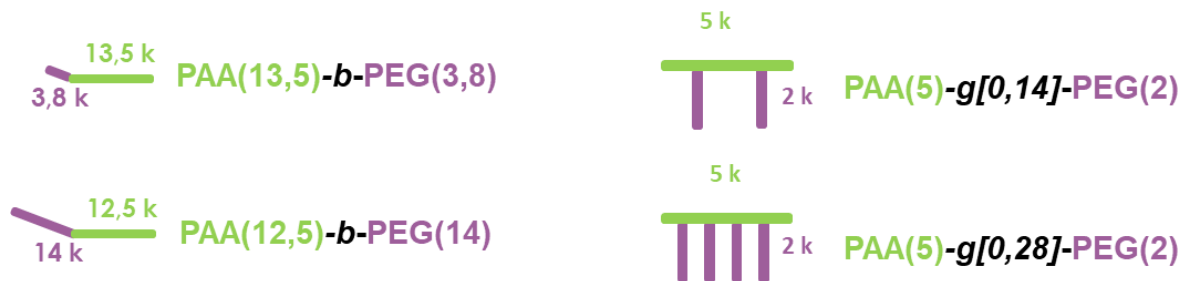
Figure 15 : Structure des copolymères PAA- b/g -PEG utilisées dans cette étude. A. Copolymère à blocs PAA- b -PEG formé par la liaison d'une chaîne PEG à l'extrémité du polymère principal PAA. B. Copolymère greffé PAA- g -PEG formé par l'addition de plusieurs chaînes PEG sur les groupements acides carboxyliques du polymère principal PAA.
