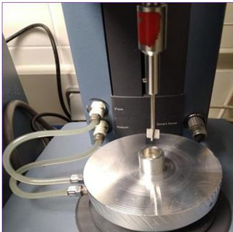
Figure 4 : Géométrie à ailettes conçue pour caractériser les échantillons de gel.
