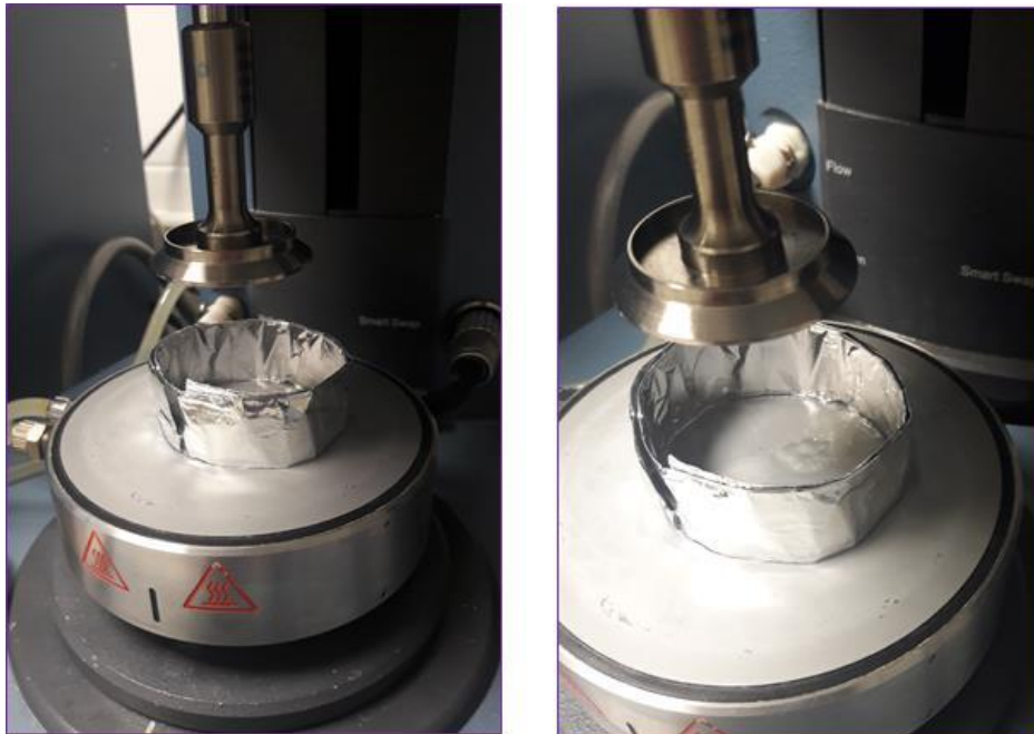
Figure 3 : Moule en aluminium conçu pour empêcher l'étalement excessif de l'échantillon au-delà des limites de la géométrie de mesure.
