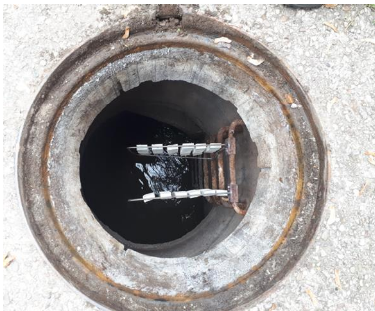
Figure 37 : Echantillons de pâtes de ciment placés sur le site S3
