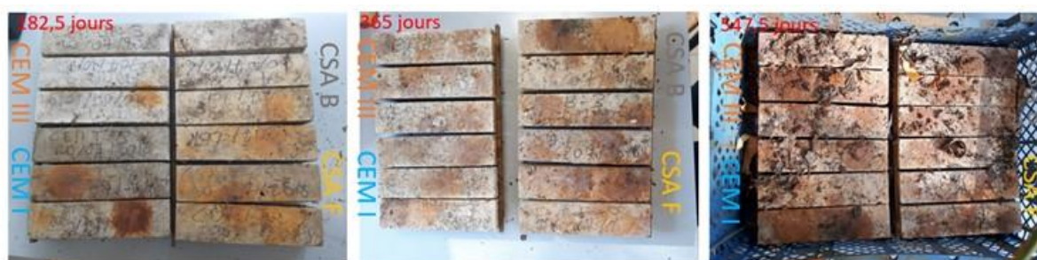
Figure 73 : Aspect des mortiers sur le site S1 au cours des 18 mois d'exposition
