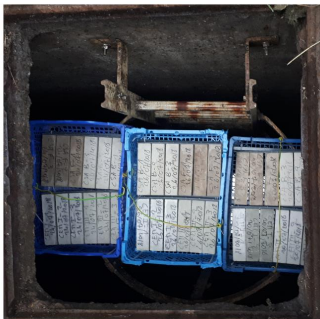
Figure 34 : Mise en place des mortiers sur le site S1
