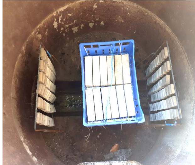
Figure 35 : Echantillons de pâtes de ciment et de mortiers placés sur le site S2u
