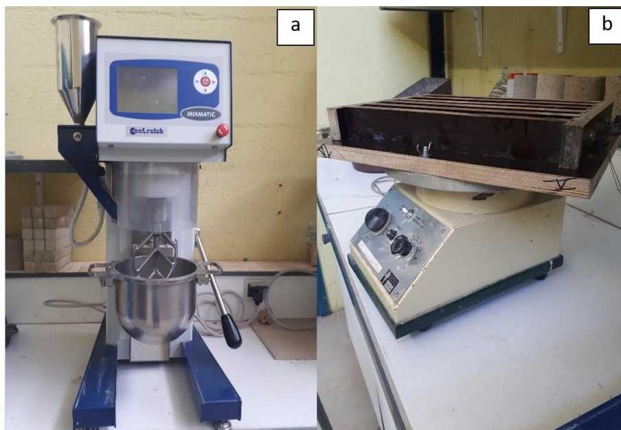
Figure 19 : Matériels de fabrication des pâtes de ciment a. malaxeur et b. table à choc
