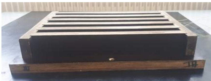
Figure 30 : Moule 330×45×20 mm 3 pour le coulage des pâtes de ciment
