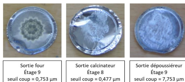
Figure 74 : Filtres de l'ELPI+ après collecte de particules en différents points du prototype
