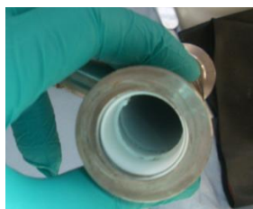
Figure 42 : Dépôt de matière dans une canalisation suite à une vitrification dans STREAM
