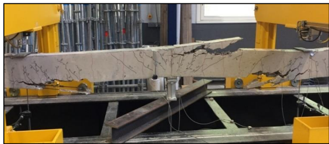
(b) Mode de rupture par délamination du béton d'enrobage.
