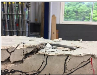
(a) Mode de rupture par arrachement (pull-out) des joncs CFRP.
