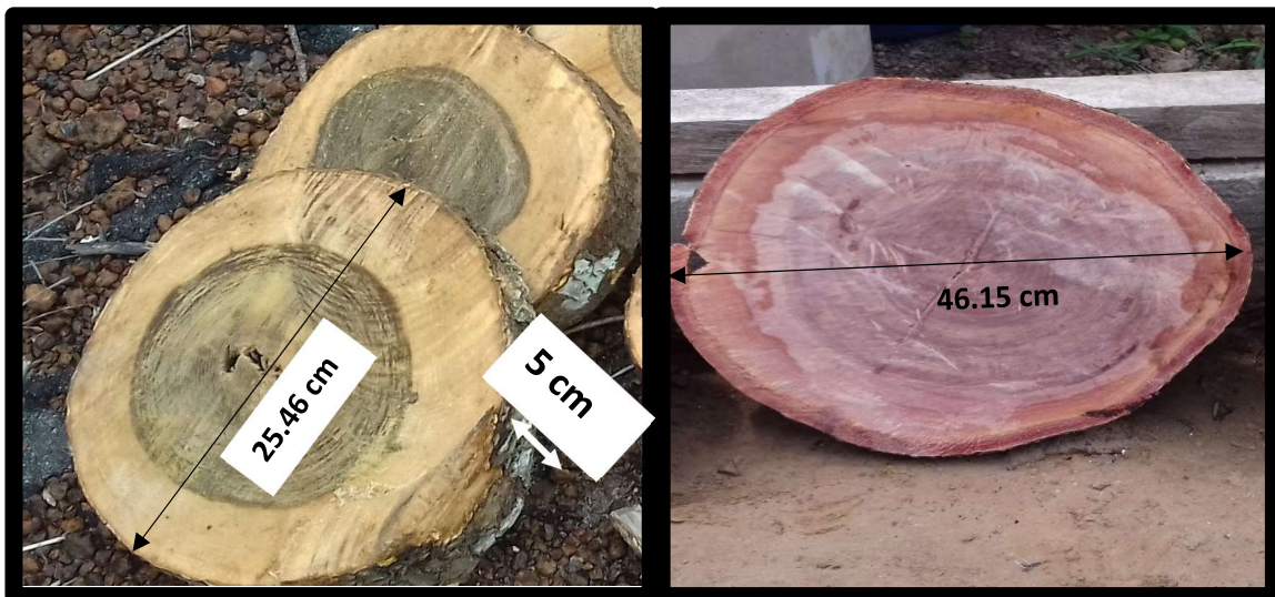
Figure 35 : Rondelles de bois de R. racemosa (collectés à Alenakiri , et présentant un diamètre de 46, 15 cm) et d' Avicennia germinans (collectés à Oveng, et montrant un diamètre de 25,46 cm et une épaisseur de rondelle de 5 cm)
