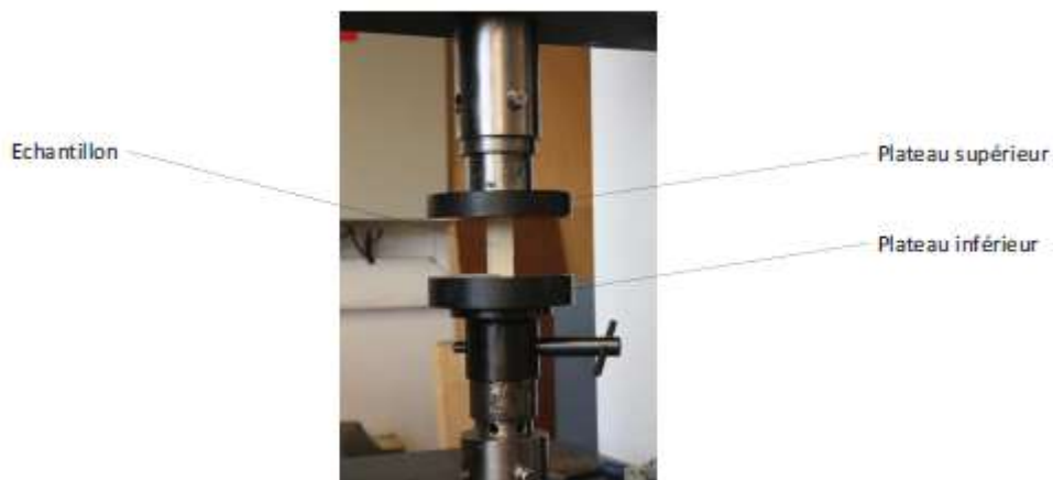
Figure 38 : Essai quasi statique de compression axiale
