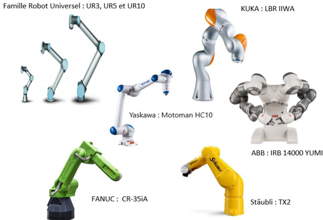
FIGURE 1.3 – Différents modèles (de divers fabricants et architectures) de robots collaboratifs sur le marché actuel
