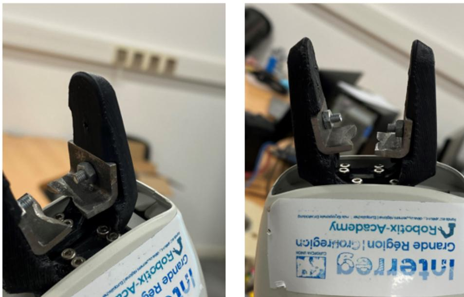
FIGURE 5.15 – Pince proposée montée sur le robot
