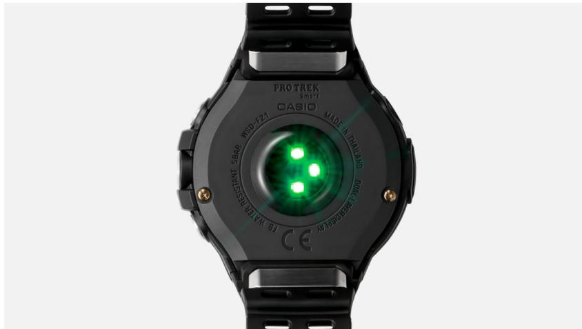
FIGURE 2.11 – Capteur de fréquence cardiaque utilisé dans les montres et bracelets connectés
