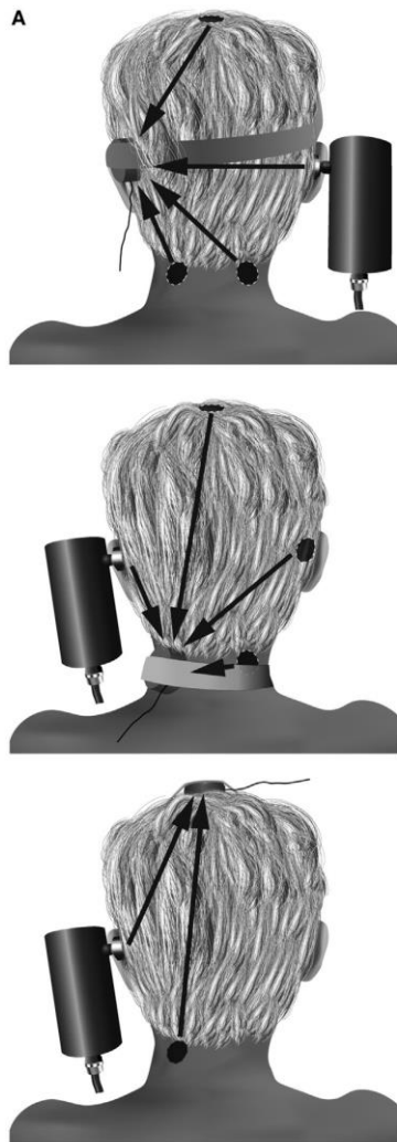
Fig 2. Etude de la radiation de vibrations appliquées au crâne (vertex, mastoïdes, région cervicale) par un vibreur 100 Hz. A : analyse par capteurs piezo electriques (Laboratoire de physique ENSE3. Collaboration M. Ouedraogo E.). B : résultats des transferts trans-crâniens et crânio-cervicaux (in Neuroreport 2016) (15).
