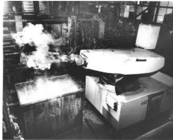
Figure 12: Robot industriel Unimate installé sur les lignes de productions de General Motors en 1961
