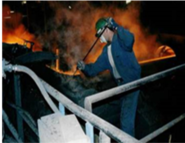
Figure 8: Illustration du grattage d'un canal
