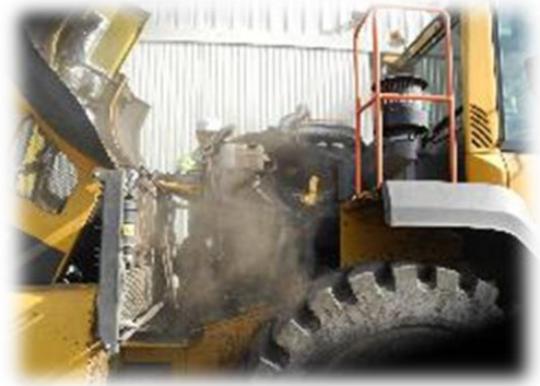
(f) Le dépoussiérage d'un engin à l'aide d'une soufflette
