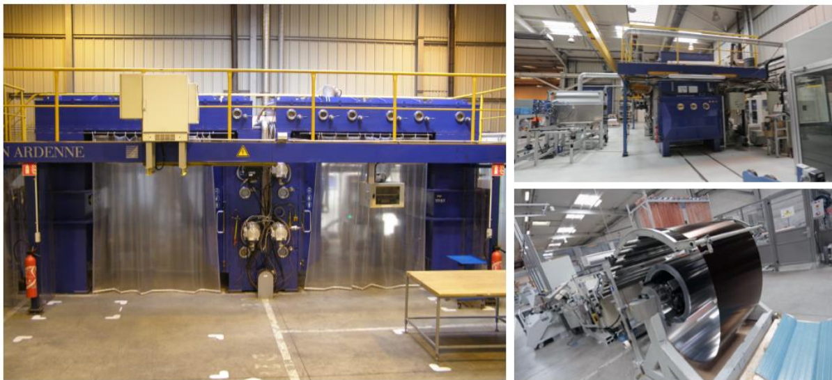
Fig. III.11 Photographie de la machine de dépôt industrielle et des bobines d'aluminium utilisées par la société Viessmann pour la fabrication des panneaux solaires.
