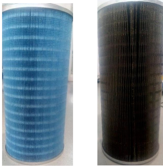
Figure 4.14 : Photos de la cartouche \alpha=6 propre (bleu) et après les cycles colmatage/décolmatage.
