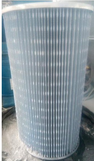
Figure 4.23 : Photo d'une cartouche plissée ( \alpha=3 ) après les cycles de décolmatage avec une application du précoating avant la filtration des nanoparticules.
