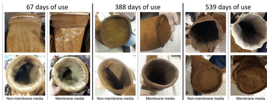
Figure 1.3 : Photos de manches filtrantes après utilisation pour la filtration des particules ultrafines métalliques (Mugica et al., 2014).
