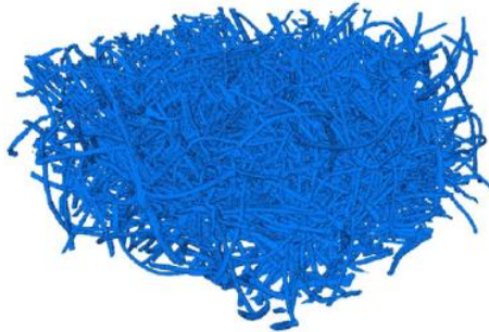
Figure 1.4 : Modèle de la structure d'un média fibreux (Soltani et al., 2014).
