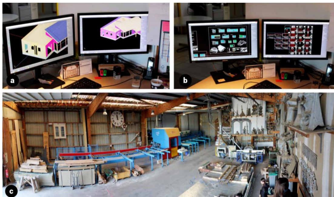
Figure 109. Photographies prises au cours de nos visites au sein de l'entreprise de charpente. Les photographies représentent : le modèle 3D détaillé sur cadwork (a), les plans à viser et les documents de fabrication (b) et la machine à commande numérique qui exploite les fichiers cadwork pour les découpes (c). Source : (Hochscheid 2015)
