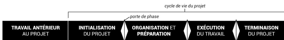
Figure 98. Représentation du cycle de vie du projet dans le PMBOK, d'après (PMI 2017)
