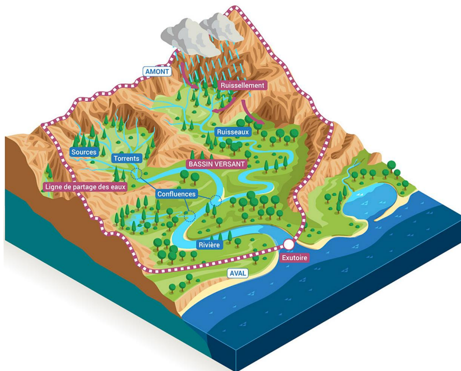
Figure 21. Représentation du bassin versant et des éléments qui le composent. Les lignes de partage des eaux définissent les limites du bassin versant. En amont, les précipitations alimentent, par le biais de ruissellement, les ruisseaux de tête de bassin. La confluence des différentes rivières et ruisseaux en aval se fait jusqu'à l'exutoire, point de convergence des eaux du bassin versant (réalisation Matthieu Nivesse ; d'après OIEau, 2018)
