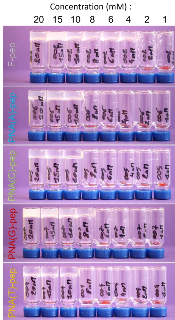
Figure SII-2 Photos des hydrogels subissant le test d'inversion de tube (Tris.HCl (1 M, pH = 7.4)) à différentes concentrations (de 1 à 20 mM).
