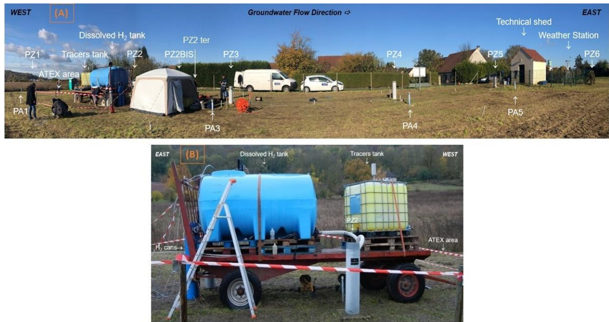
Figure 53 : Photographies présentant les différents dispositifs d'injection d'H 2 dissous sur le site de Catenoy (Lacroix et al., 2020b; Gombert et al., 2021).
