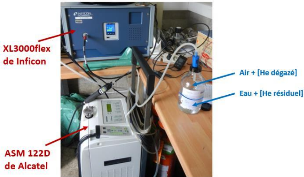
Figure 30 : Protocole de mesures d'He dissous dans un contenant d'1L par dégazage à la suite de l'agitation mécanique par les deux analyseurs XL3000flex de Inficon et ASM 122D de Alcatel
