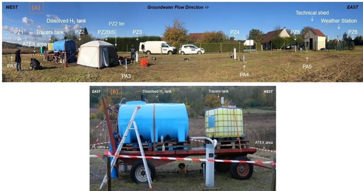
Figure 53 : Photographies présentant les différents dispositifs d'injection d'H<sub>2</sub> dissous sur le site de Catenoy (Lacroix et al., 2020b; Gombert et al., 2021).
