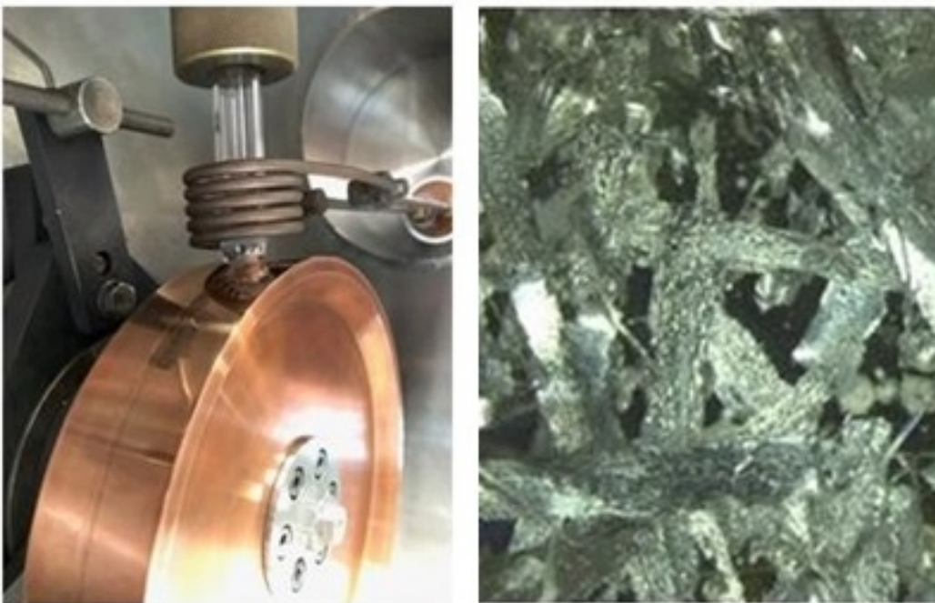
FIGURE III.17: (A gauche) Dispositif expérimental d'hypertrempe sur roue disponible au sein de notre laboratoire ; (A droite) Aspect en microscopie optique des rubans obtenus (Grossissement 2.5).
