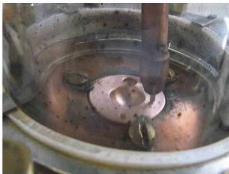
FIGURE III.1: Four de fusion à arc avec son creuset et son électrode. Institut Jean Lamour, Nancy
