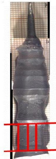
FIGURE I.2: Image d'un monocristal d'aluminium obtenu par tirage Czochralski. En rouge la partie dans laquelle ont été taillés les échantillons à étudier.
