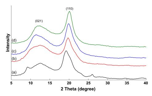
Figure 2.6. XRD of: (a) extracted chitosan, (b) CS-80, (c) CS-90 and (d) CS-95.
