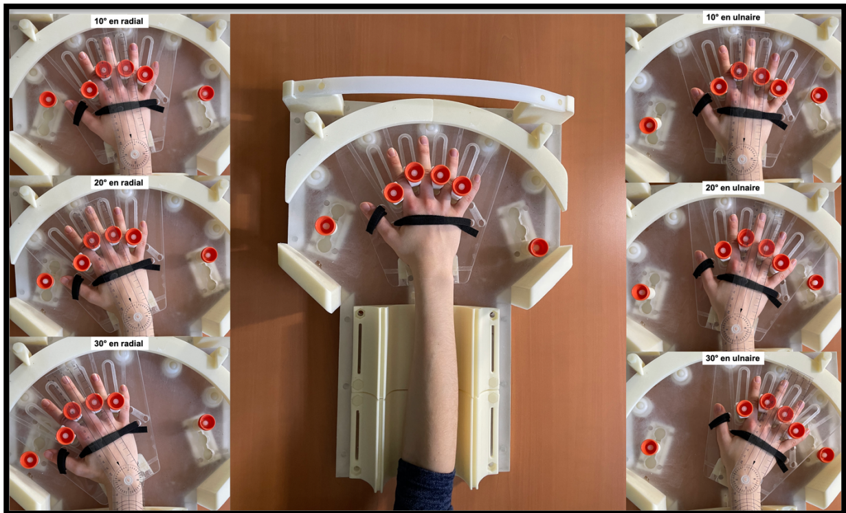
Figure 56. Photographies illustrant l'installation du membre droit d'un volontaire sain sur le dispositif avec son poignet positionné à 0° puis en inclinaison radiale à 10°, 20°, 30° et en inclinaison ulnaire à 10°, 20°, 30°.
