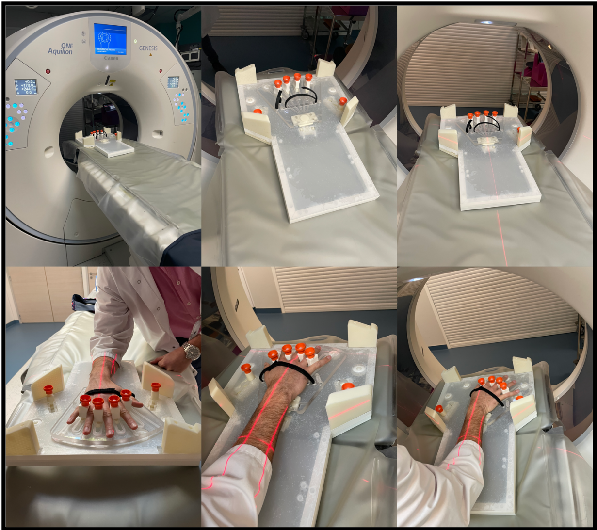
Figure 54. Photographie montrant la compatibilité en termes d'encombrement du dispositif avec la table d'examen du scanner Aquilion One du service d'imagerie Guilloz. À noter la simulation hors acquisition scanographique, de l'installation sur le dispositif du membre supérieur droit d'un médecin volontaire.
