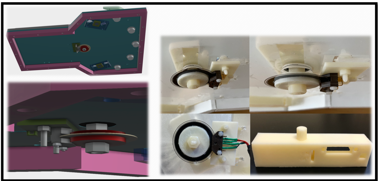
Figure 53. Vues 3D et photographies du capteur d'analyse des amplitudes de mouvement du poignet. À noter en bas à droite, l'impression 3D de la pièce servant de support à l'interrupteur ON/OFF et au passage du câble de liaison du capteur à la console TDM ou IRM.
