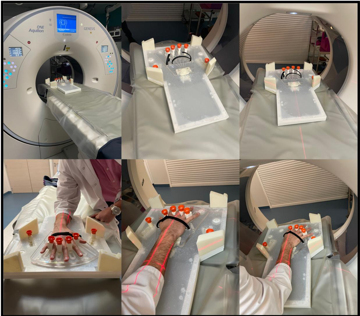
*Figure 54. Photographie montrant la compatibilité en termes d'encombrement du dispositif avec la table d'examen du scanner Aquilion One du service d'imagerie Guilloz. À noter la simulation hors acquisition scanographique, de l'installation sur le dispositif du membre supérieur droit d'un médecin volontaire.*
