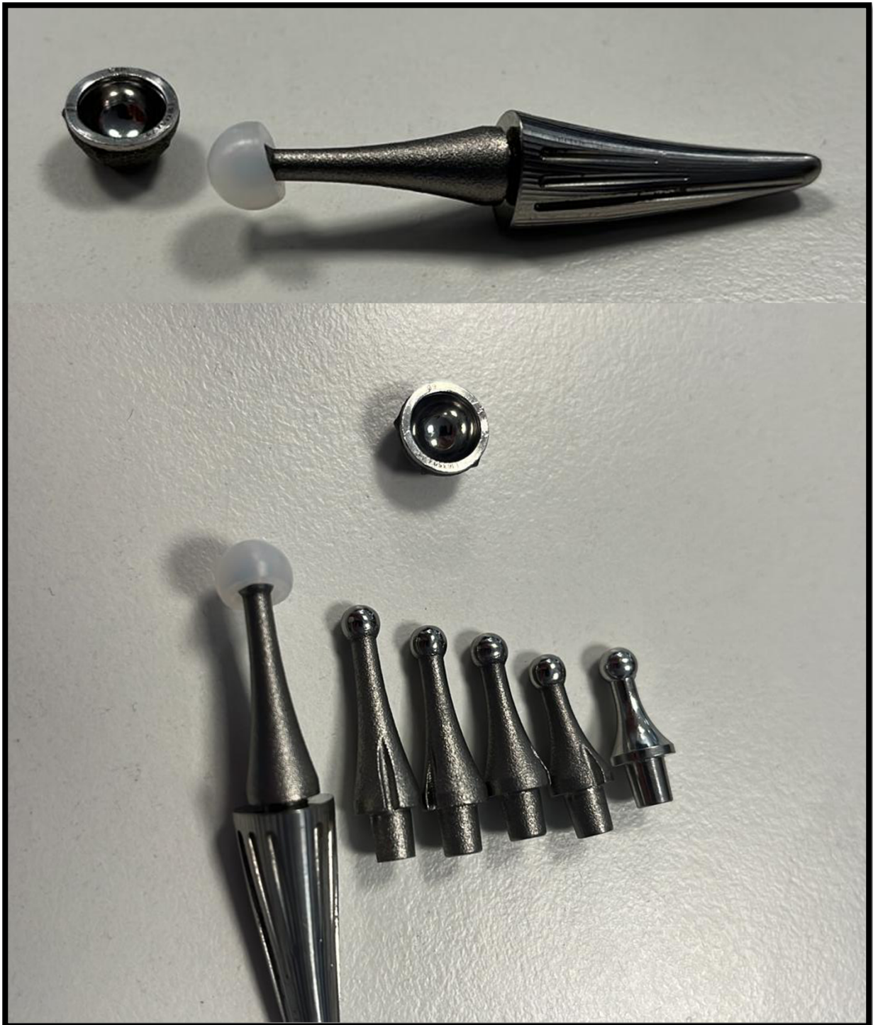
Figure 50. Photographies d'un modèle de prothèse scapho-métacarpienne avec différentes tailles de col, imprimée en 3D titane.
