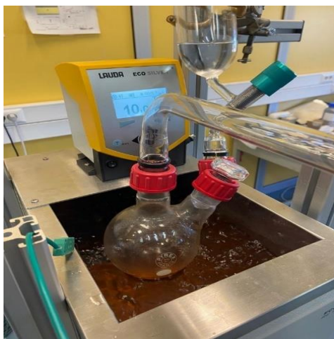
fig. 81 : générateur de vapeur d'eau
