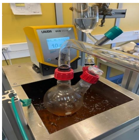
fig. 81 : générateur de vapeur d'eau
