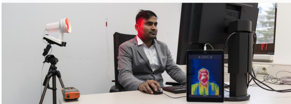
fig. 154 : Surveillance thermographique du confort thermique
