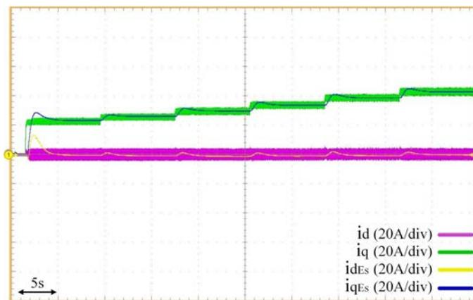
FIGURE 4.18 – Courants estimés et mesurés lorsque  $i_q$  change pour  $i_e = 3A$ .
