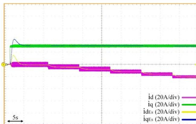
FIGURE 4.19 – Courants estimés et mesurés lorsque  $i_d$  change pour  $i_e = 3A$ .
