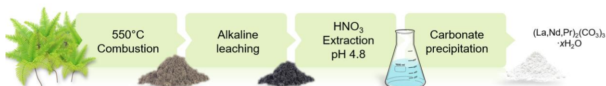
Figure 3 : Procédé de récupération des terres rares à partir des cendres de D. linearis développé dans cette thèse
