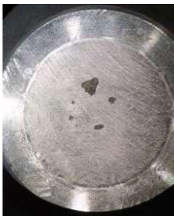
Figure 2.1 : Exemple d'un échantillon de Chassigny (2524sp1, MNHN) préparé dans une matrice d'indium pressée dans une bague d'aluminium (diamètre = 2.5cm).
