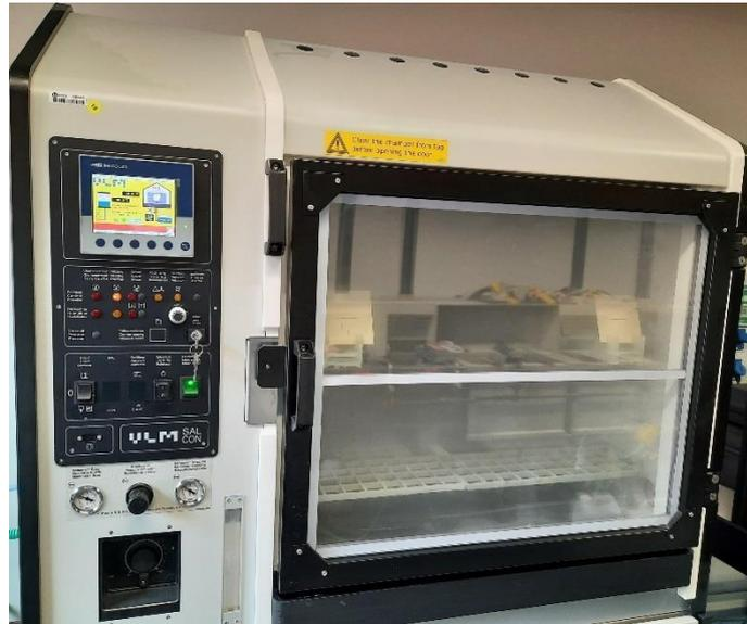
*Figure II.9. Enceinte bouillard salin « CCT 400-FL-I »*
