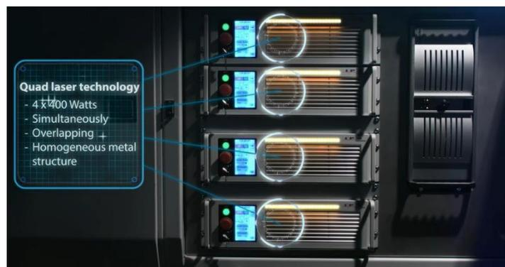
Figure 48 : Les quatre lasers dans la machine SLM<sup>®</sup> 500 [106]
