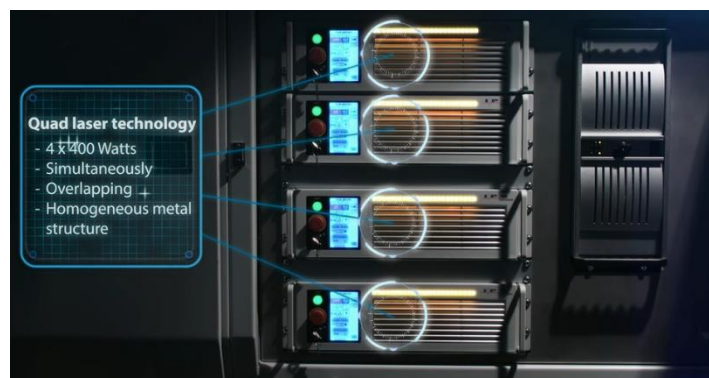
Figure 48 : Les quatre lasers dans la machine SLM ® 500 [106]
