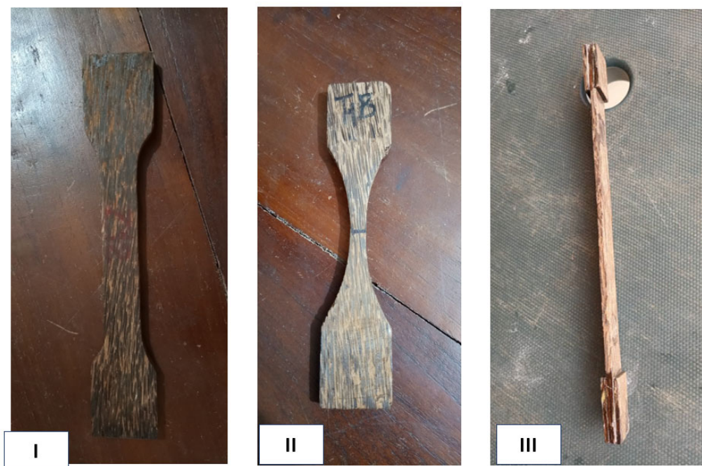
Figure 3-3 : Différents types d'éprouvettes de rônier essayées en traction
