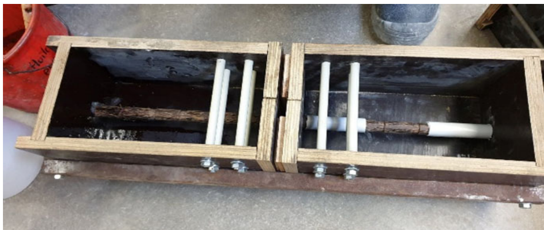
Photo 4-2 : Dispositif d'essai d'adhérence par la méthode de traction par flexion
