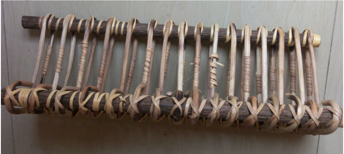
Photo 5-2 : Assemblage des armatures en rotin sur celles en rônier
