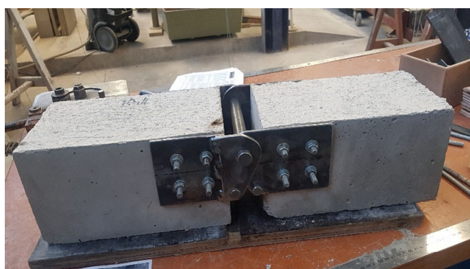
Photo 4-4 : Echantillon de pontre avec le dispositif d'essai permettant la rotation
