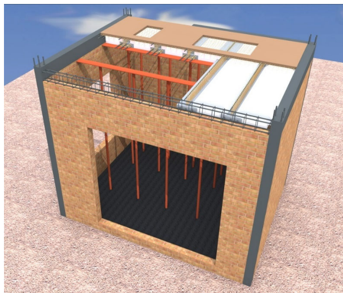
Figure 5-10 : vue 3D montrant les nervures à armatures de rônier et de rotin dans la dalle du bâtiment
