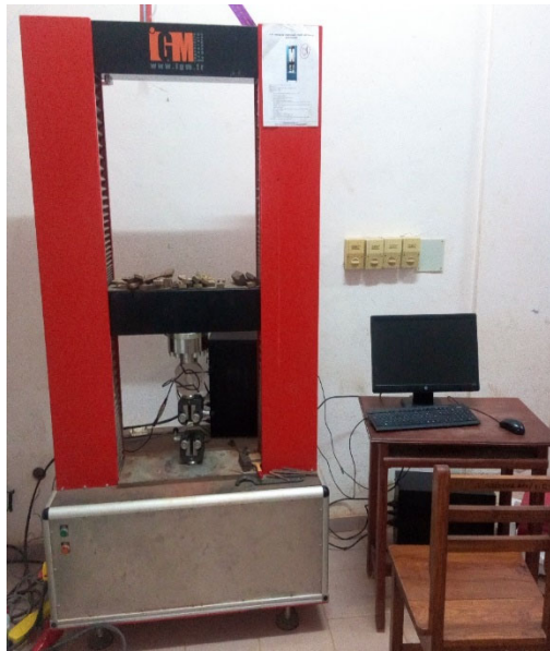
Figure 3-1 : Machine d'essai et le dispositif d'application de la charge de traction (Ex ESTBR Abomey)
