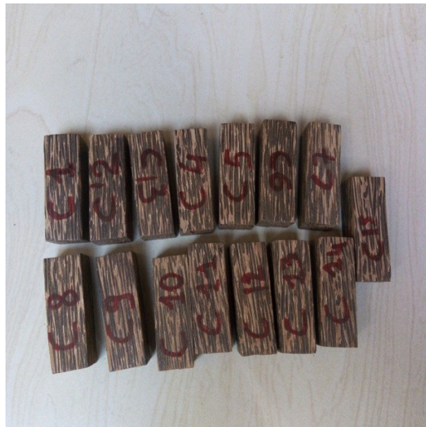
Figure 3-4: Quelques échantillons des éprouvettes de rônier pour la compression axiale
