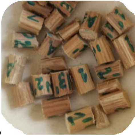
Photo 3-3: éprouvettes pour essai de retrait-gonflement (a) liane de rotin, (b) bois de rônier
