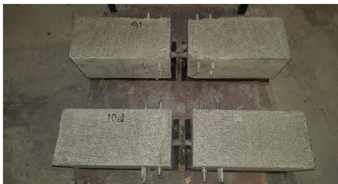
Photo 4-3 : Echantillon après démoulage
