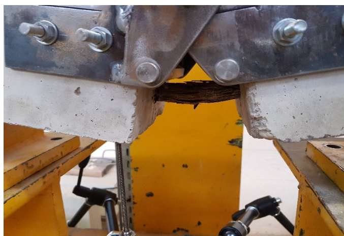
Photo 4-6 : Rupture de l'adhérence après sollicitation en flexion par traction
