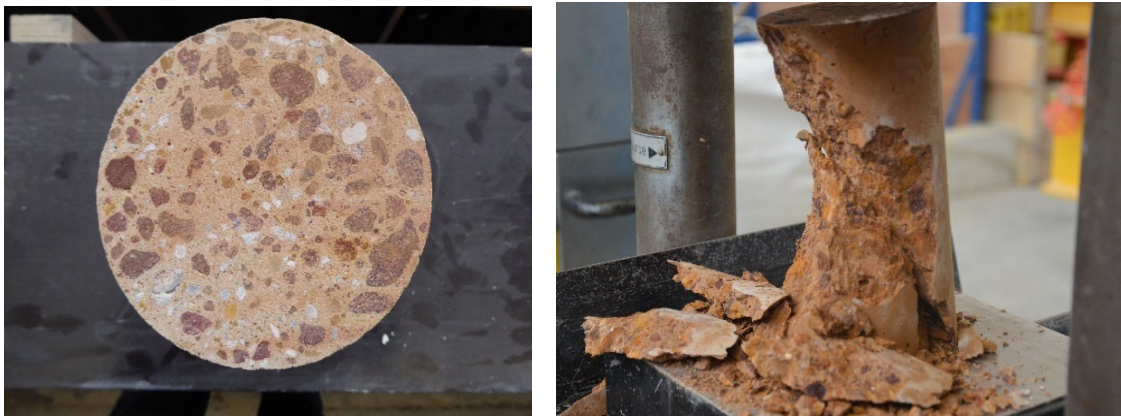
Figure 2-17 : Aspect du béton de latérites lavées, avant (a) et après (b) écrasement en compression
