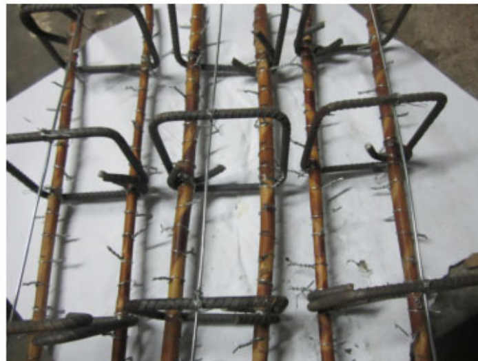
Figure 1-28: Armatures des poutres en flexion [106]
