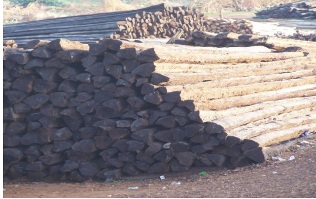
Photo 1-5: Lattes obtenues après découpe des grumes de rônier [37]
