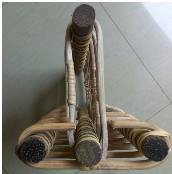
Photo 5-3 : Disposition des armatures en rotin sur celles en rônier
