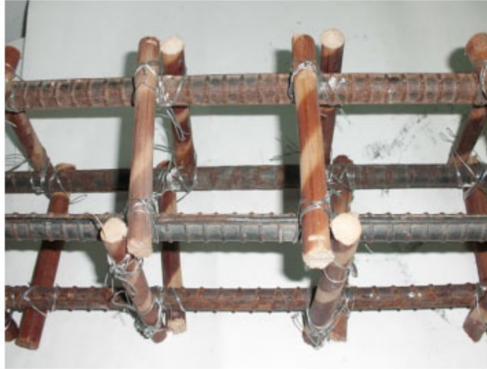
Figure 1-29 : Rotin (Zali) comme armature transversale dans les poutres en béton armé [106]
