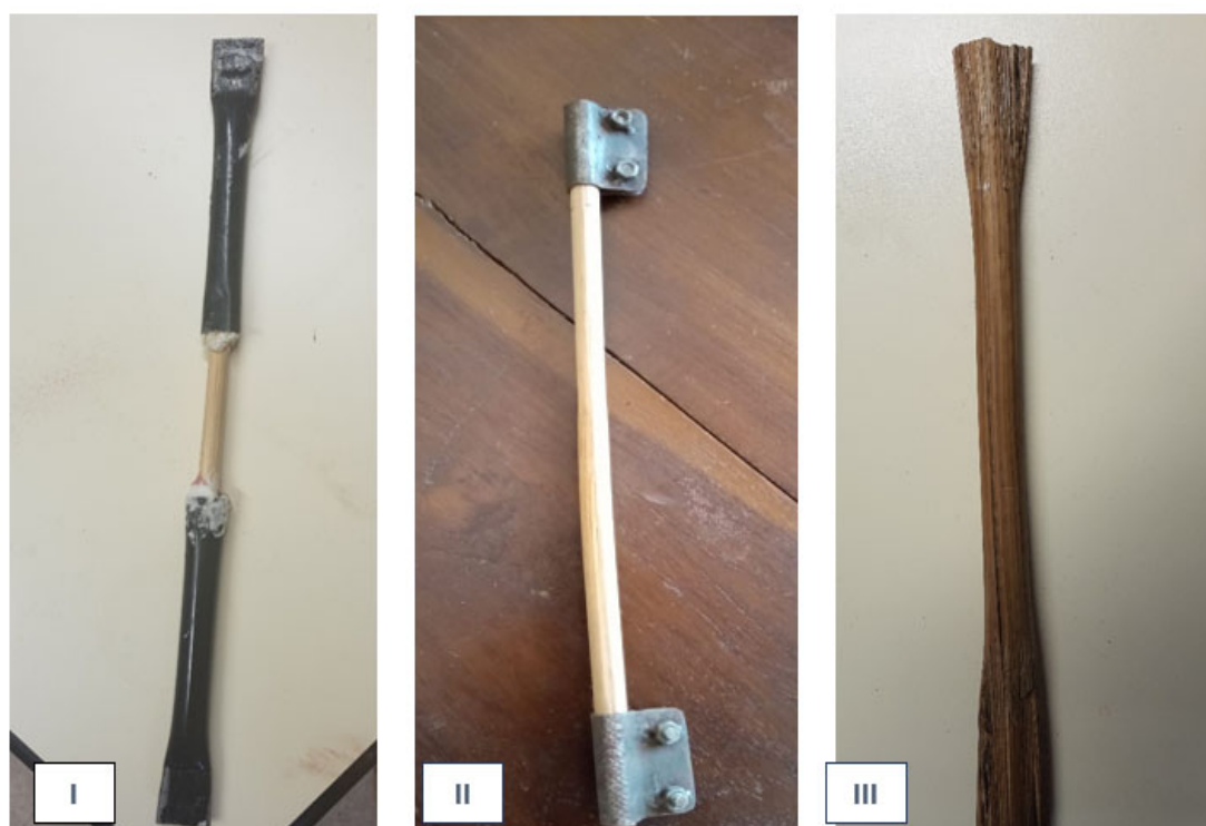
Figure 3-2 : Les différents types d'échantillons d'essai de rotin en traction
