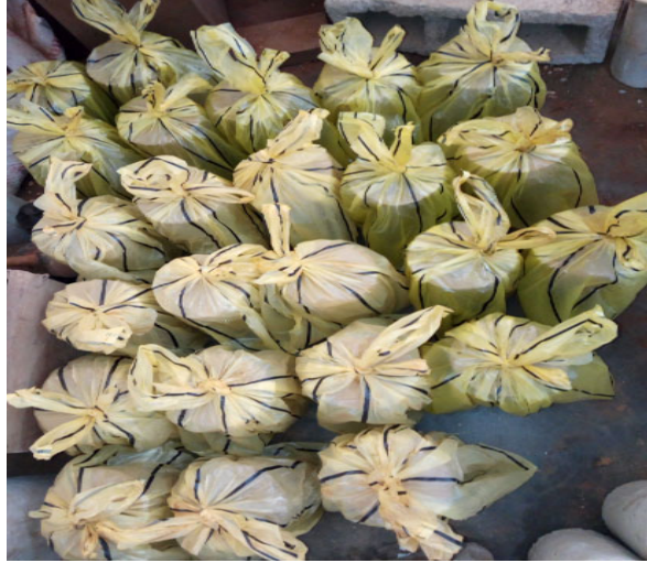
Photo 2-3: Conservation des éprouvettes
