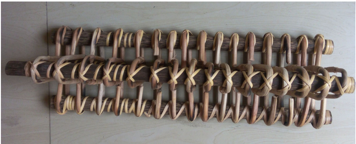
Photo 5-1: Répartition des armatures en rotin sur celles en rônier
